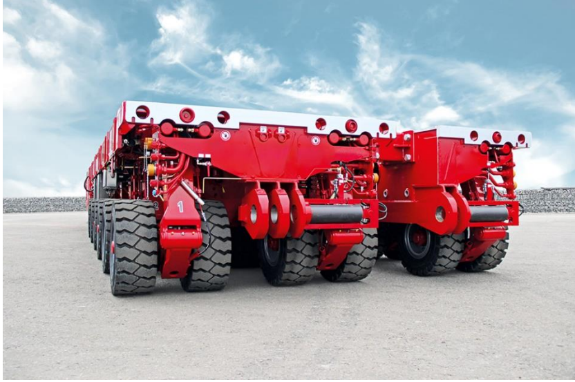
Resim 3. 14- SPMT (Self Propelled Modular Transporter), kendinden tahrikli modüler taşıyıcı, ( http://www.scheuerle.com )
