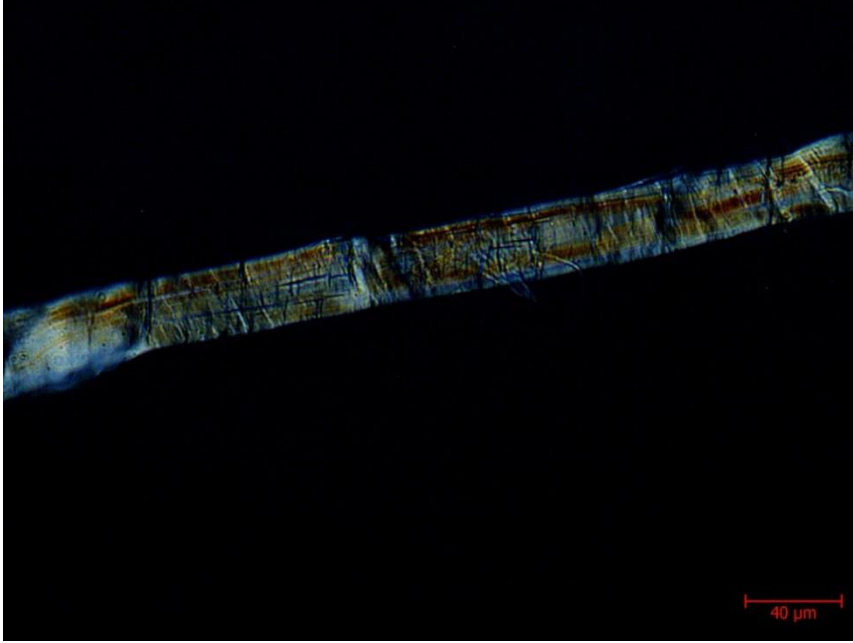
Resim 4.45. Yeni Cami 980'den alınan kâğıt örneğine ait farklı bir lifin mikroskop görüntüsü, 500x büyütme, polarize ışık
