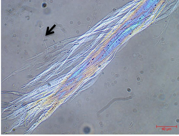
Resim 4.26. Fatih 2427'den alınan kâğıt örneğine ait lif demeti ve fibrilasyon görüntüsü, 500x büyütme
