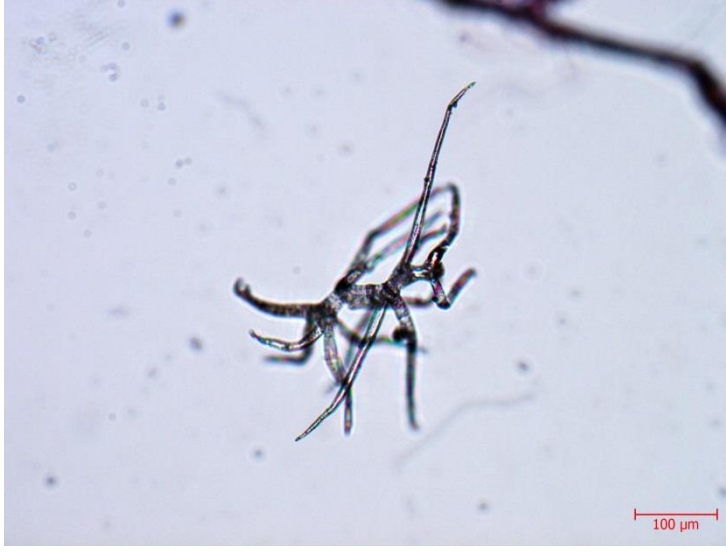
Resim 4.55. Hacı Mahmud Efendi 2252'den alınan kâğıt örneğine ait lif-trikom yapısı görüntüsü, 200x büyütme
