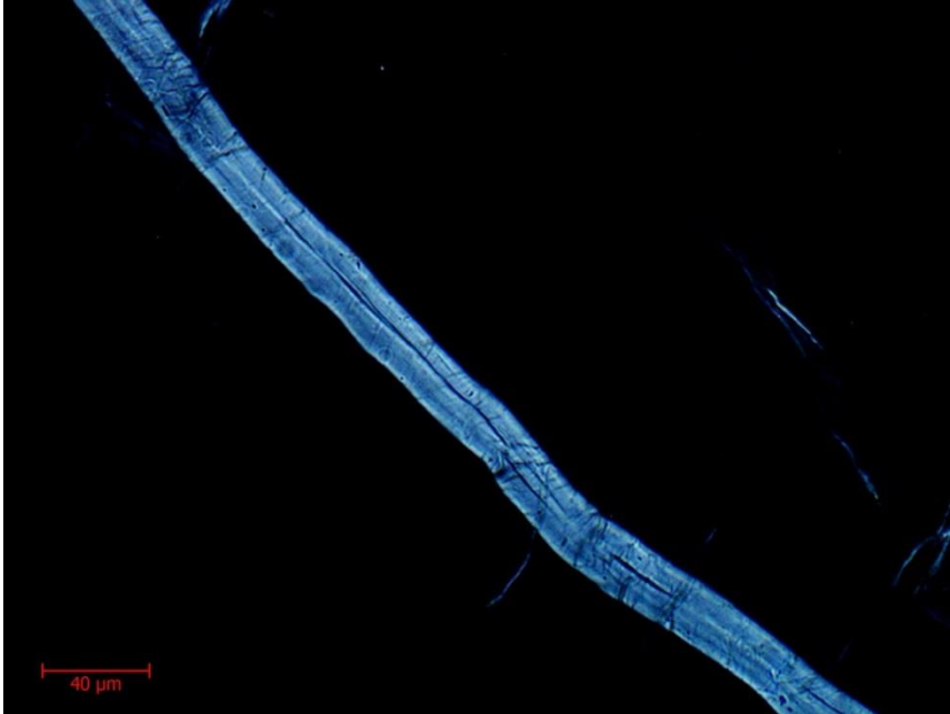
Resim 4.63. Ragıp Paşa 1470-003'ten alınan kâğıt örneğine ait farklı bir lifin mikroskop görüntüsü, 500x büyütme, polarize ışık
