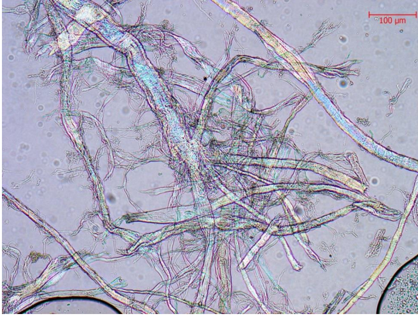
Resim 4.73. Şehid Ali Paşa 1351-001'den alınan kâğıt örneğine ait lif numunesinde floroglusinol testi sonucu renk deęiřimi, 200x büyütme
