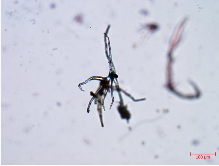
Resim 4.41. Bağdatlı Vehbi 1490-001'den alınan kâğıt örneğine ait lif-trikom yapısı görüntüsü, 200x büyütme
