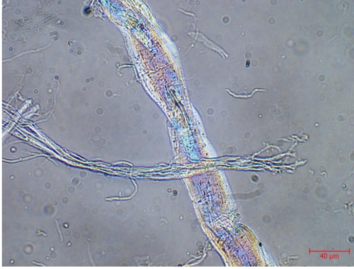
Resim 4.36. Reisülküttab 62'den alınan kâğıt örneğine ait lif-şişme (İng. swelling ) görüntüsü, 500x büyütme
