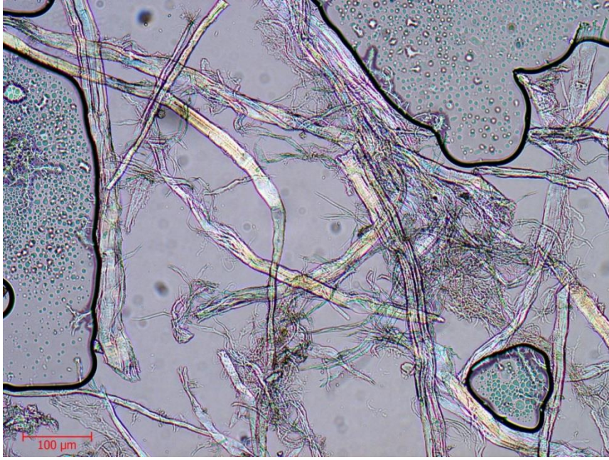
Resim 4.77. Şehid Ali Paşa 2391-001'den alınan kâğıt örneğine ait lif numunesinde floroglusinol testi sonucu renk değişimi, 200x büyütme
