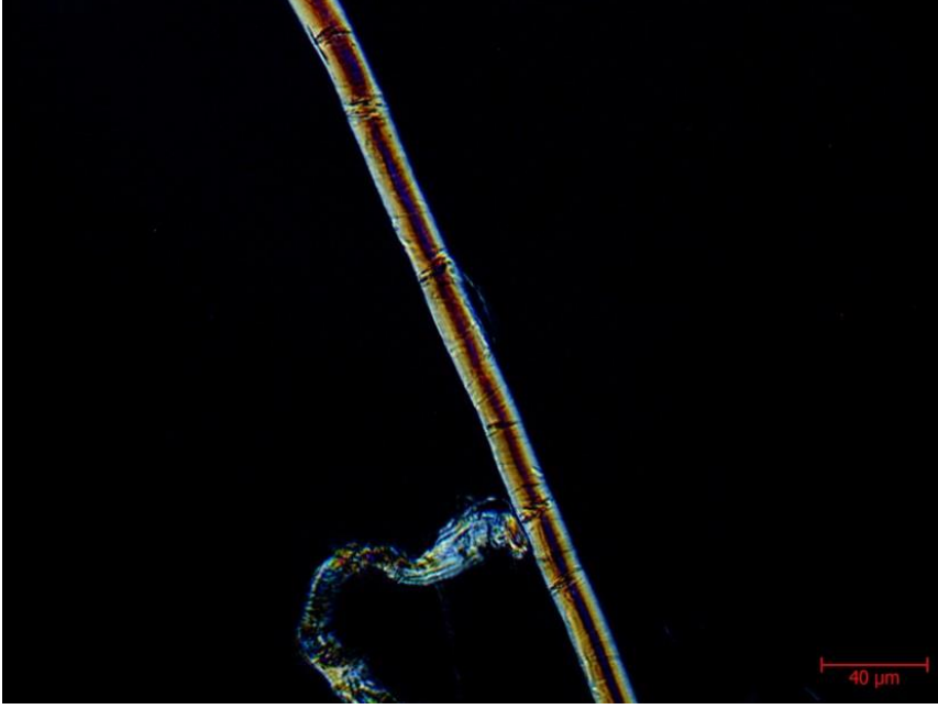
Resim 4.34. Reisülküttab 62'den alınan kâğıt örneğine ait bir lifin mikroskop görüntüsü, 500x büyütme, polarize ışık
