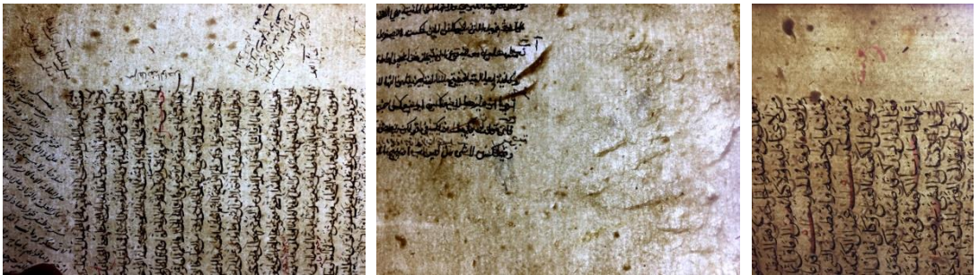
Resim 4.1. Kâğıt hamurunda lif öbekleri ve lif yığılmaları, Fatih 5047, v. 47 (sol), Fatih 1358, v. 9 (orta), Fazıl Ahmed Paşa 469 (sağ)
