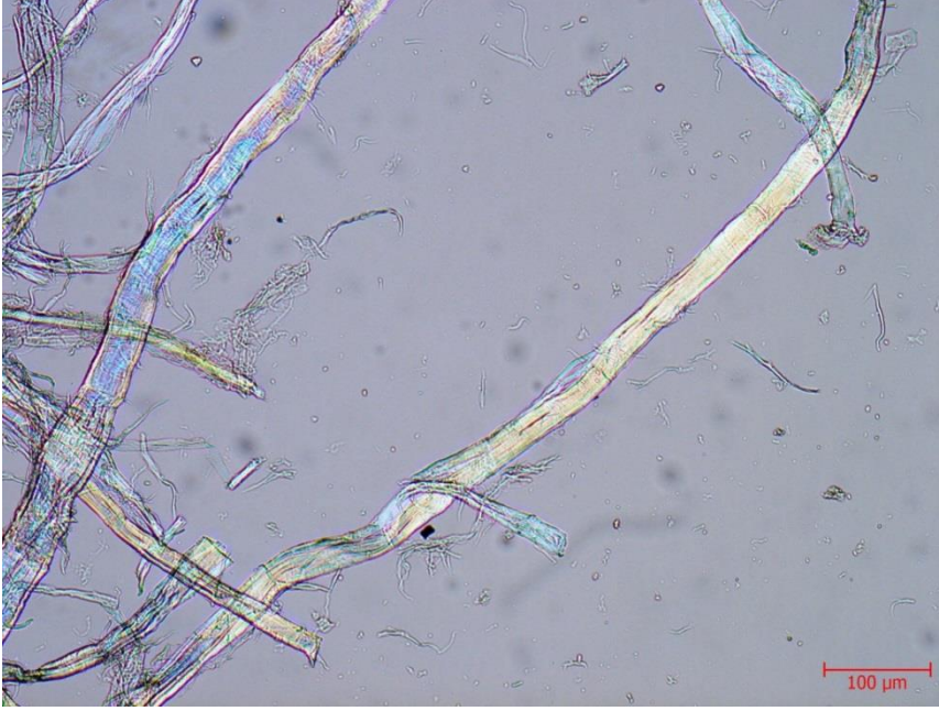
Resim 4.81. Nuruosmaniye 2159-001'den alınan kâğıt örneğine ait lif numunesinde floroglusinol testi sonucu renk deęişimi, 200x büyütme
