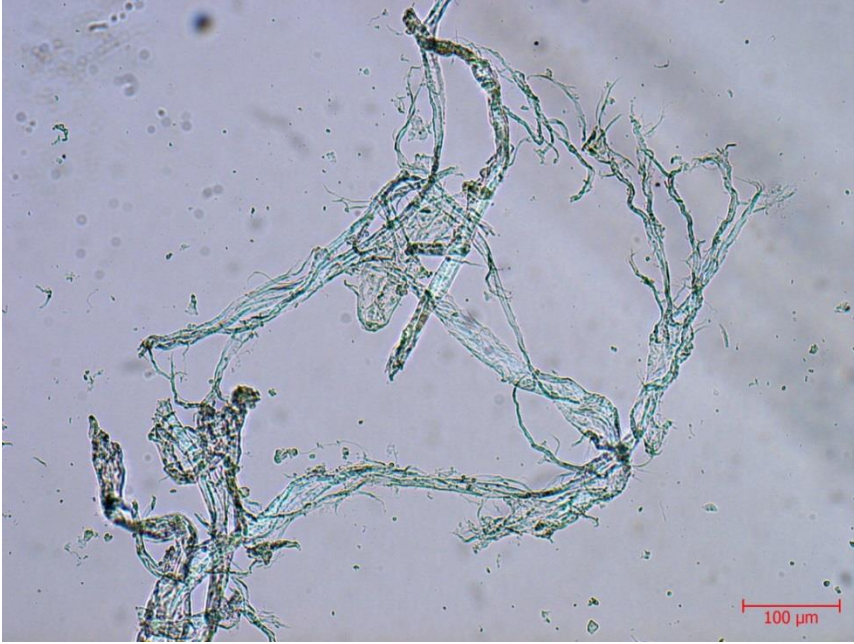
Resim 4.22. Fatih 2810'dan alınan kâğıt örneğine ait lif numunesinde floroglusinol testi sonucu renk deęişimi, 200x büyütme
