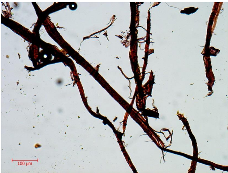
Resim 4.19. Murad Molla 1181'den alınan kâğıt örneğine ait lif numunesinde Herzberg testi sonucu renk değişimi, 200x büyütme
