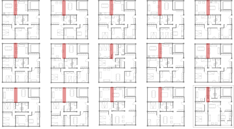
Şekil 4.40 Görüşme Sonrası Planlarda Olmayan Duvar
