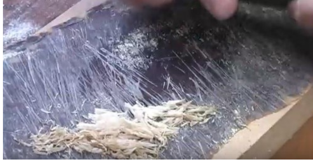
Resim 99: Bağa malzemesi tesviye 27 edilirken Kaynak ( https://www.youtube.com/watch?v=oinOCIRvBPk )
