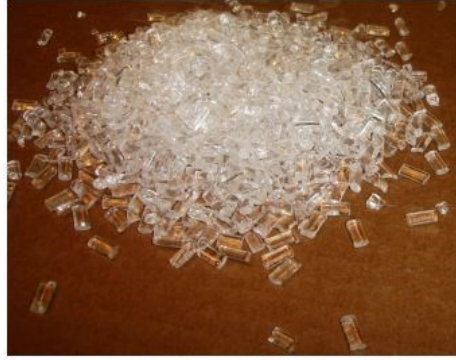
Resim 119: Eritilmeden doğal haldeki Paraloid B72 yapıştırıcısının görüntüsü (Edward,1997, sy.6)
