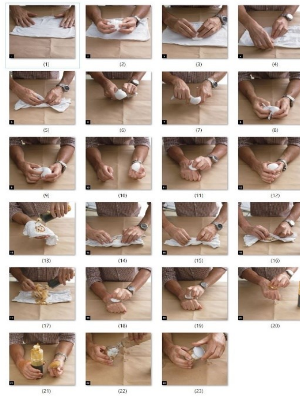
Resim 59: Gomalak cila uygulanmasında 1-24 numaralandırılarak kullanılan bez topun hazırlanışı anlatılmıştır. (Pourny, 2014)
