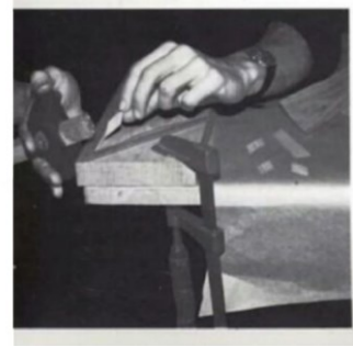
Resim 64: Kakma tekniği ile süsleme sanatına bir örnek; kakma yapılacak parçaları yerine yerleştirmek cımbız ve bunun gibi küçük aletlerle hassas çalışmayı gerektirir. (Ramond,1989:18)
