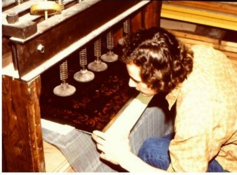
Resim 121: Doğruca ıslak tutkal üzerine yerleştirilen ince Lexan levhası, düz bir referans yüzey sağlıyor. Fotoğraf: Museum of Decorative Arts, Paris'teki mobilya koruma uzmanı Nicolas Boucher'dir. (Patrick ,1997, sy.8)
