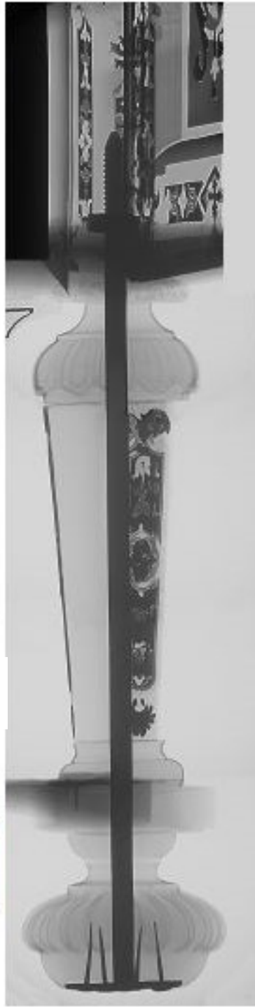
Resim 134: André-Charles Boulle yapımı Boulle- marküteri mobilyanın röntgen görüntüsü (Stefan Demeter,2006, sy.87)
