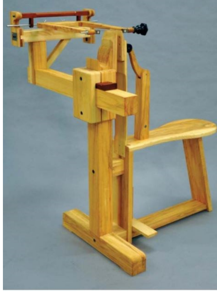
Resim 96: Chevalet (tezgâh testersi) (Furniture & Cabinetmaking Eylül 2015, sy.5)
