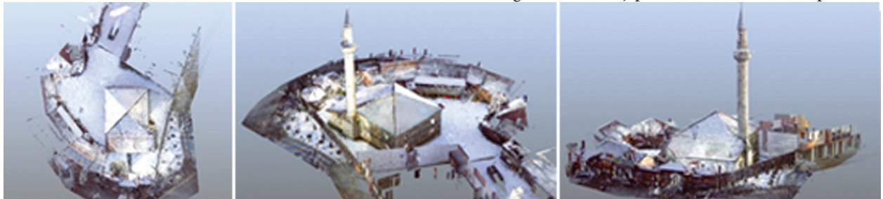
Şekil 1. Optik ve scanner sistem ile yapının ölçüm sonucu elde edilen dijital görüntü.
