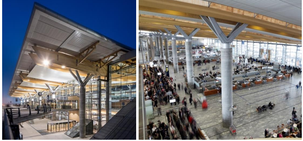
Şekil 3.28 Oslo Havaalanı, tutkallanmış lamine ahşap kirişler. (URL-21)
