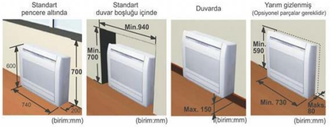
Şekil 3.19: Yer Tipi Split Klima Cihazı Montaj Seçenekleri (Anonim, 2017).
