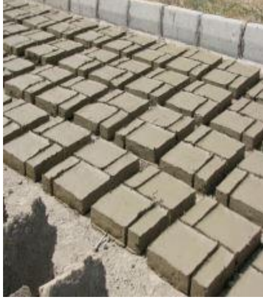
Şekil 5.4 Kerpiçlerin kuruması için dizilmesi. (ÖZTÜRK)
