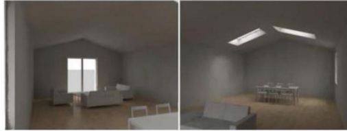
Şekil 27 Mevcut durumdaki pencere ve çatılı pencerenin verdiği ışınımlar.(Üce, Arpacioğlu, 2019, s:44) 11
