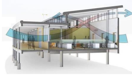
Şekil 26 Pencere boşluklarının sağladığı hava sirkülasyonunu ifade etmektedir.(URL 39)
