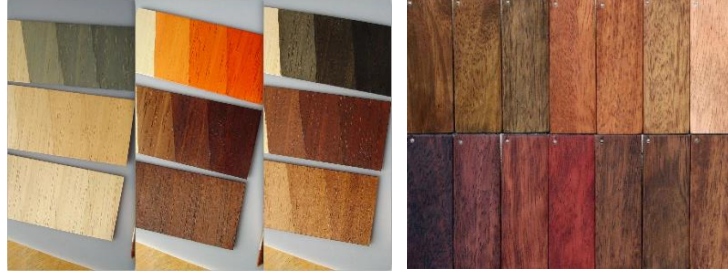
Şekil 109 Masif ağaç yüzeylerine uygulanmış 4 kat verniğin renk etkisi ve cilalanmış veya verniklenmiş doğal ahşap görünümleri. (URL 143)
