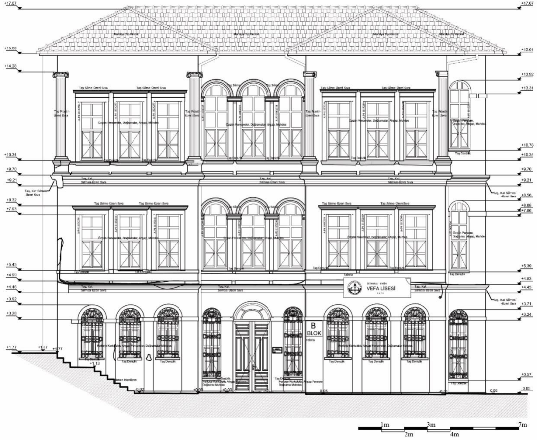
EK 13 : Güneydoğu cephesi - Rölöve
