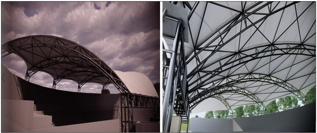
Şekil 2.1: Düzce Üniversitesi Amfi tiyatro kemer destekli üst örtü kapama tasarımı
