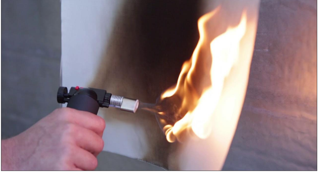
Resim 2.10: Membran kumaş alev yürütmezlik testi örneği (Url-25).
