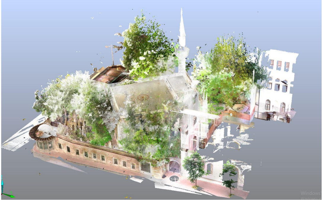
Şekil 4. Lazer tarama sonucu nokta bulutu, Besim Ömer Paşa Caddesi'nden yapı görünümü ( Ağustos 2020 ).
