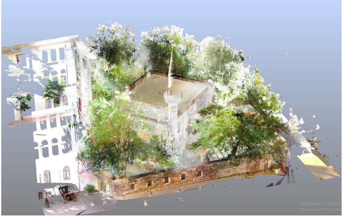
Şekil 3. Lazer tarama sonucu nokta bulutu, Kaptanı Derya İbrahim Paşa Sokağı'ndan yapı görünümü ( Ağustos 2020 ).
