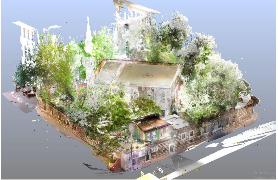
Şekil 2. Lazer tarama sonucu nokta bulutu, Prof.Ümit Yaşar Doğanay Sokağı ile Kaptanı Derya İbrahim Paşa Sokağı köşesinden yapı görünümü ( Ağustos 2020 ).
