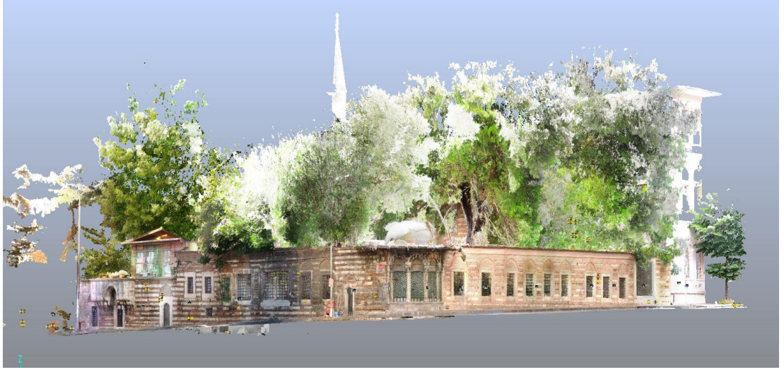
Şekil 1. Lazer tarama sonucu nokta bulutu, Besim Ömer Paşa Caddesi ile Prof.Ümit Yaşar Doğanay Sokağı köşesinden yapı görünümü ( Ağustos 2020 ).
