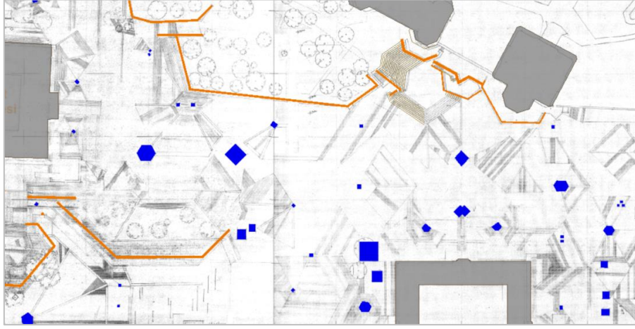
Şekil 2. 22 Orijinal çizim üzerine zemin suyu toplama noktalarının şematik gösterimi.
