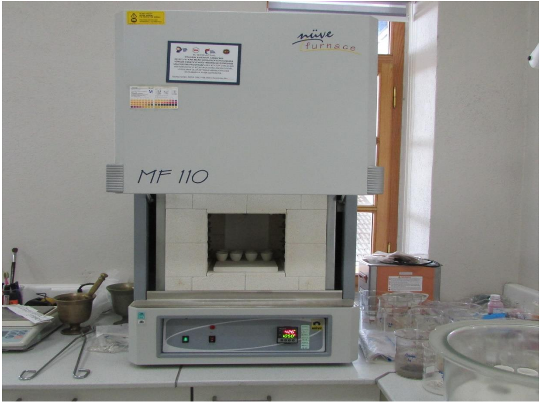
A: Numuneler kül fırını içerisindeyken
