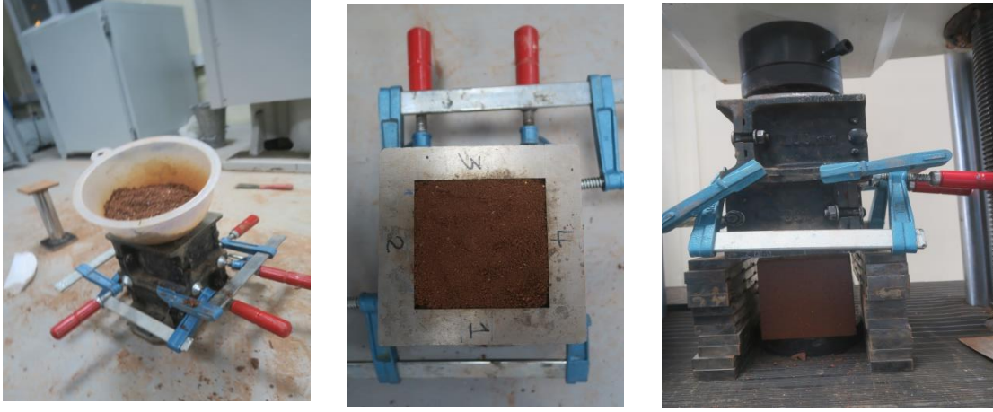
A: Karışım sıkıştırma sırasında ve sonrasında
