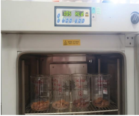
A: Etüvde numunelerin kurutulması
