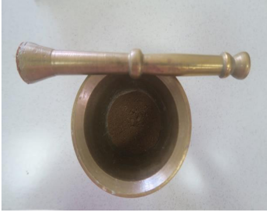
A: Deney için numunenin öğütülmesi
