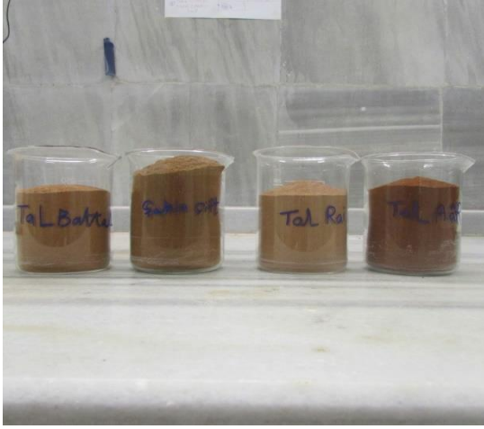
A: Likit limit için toprağı hazırlamak
