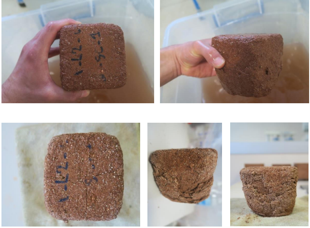
Şekil 78 : %2 kireç ve %10 alçı stabilizatörlü numunelerin kurutulduktan sonraki görünüşü
