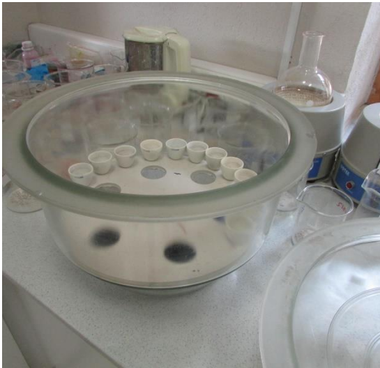
B: Örneklerin kızdırma sonrası desikatörde soğutulması
