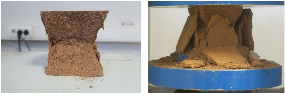
Şekil 76 : Kireç stabilizatörlerle örneklerin basınç deneyi sonrası
