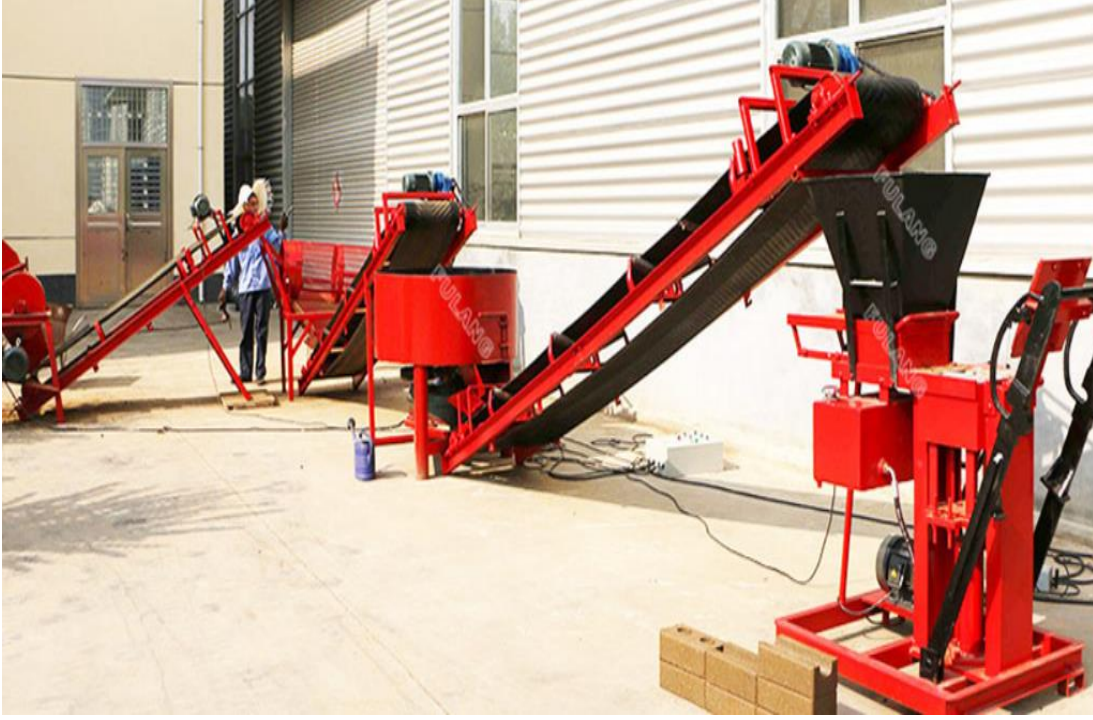
Şekil 17: Üretilmiş Sıkıştırılmış Kerpiç Blokların Üretim Hattı (Url: 15)
