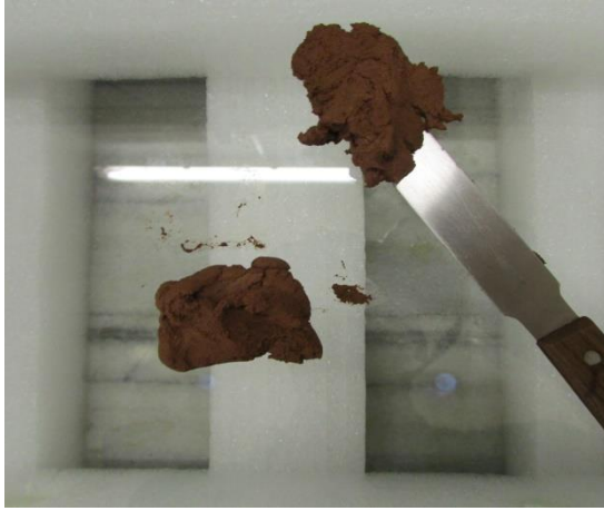
A: Plastik limit deneyi için hazırlanan toprak
