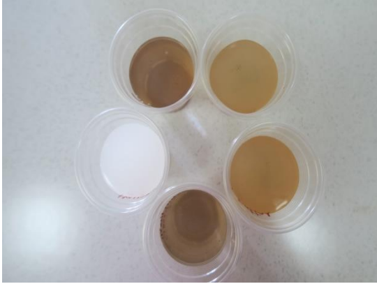
C: Tuz ölçümü yapılacak toprak çözeltileri
