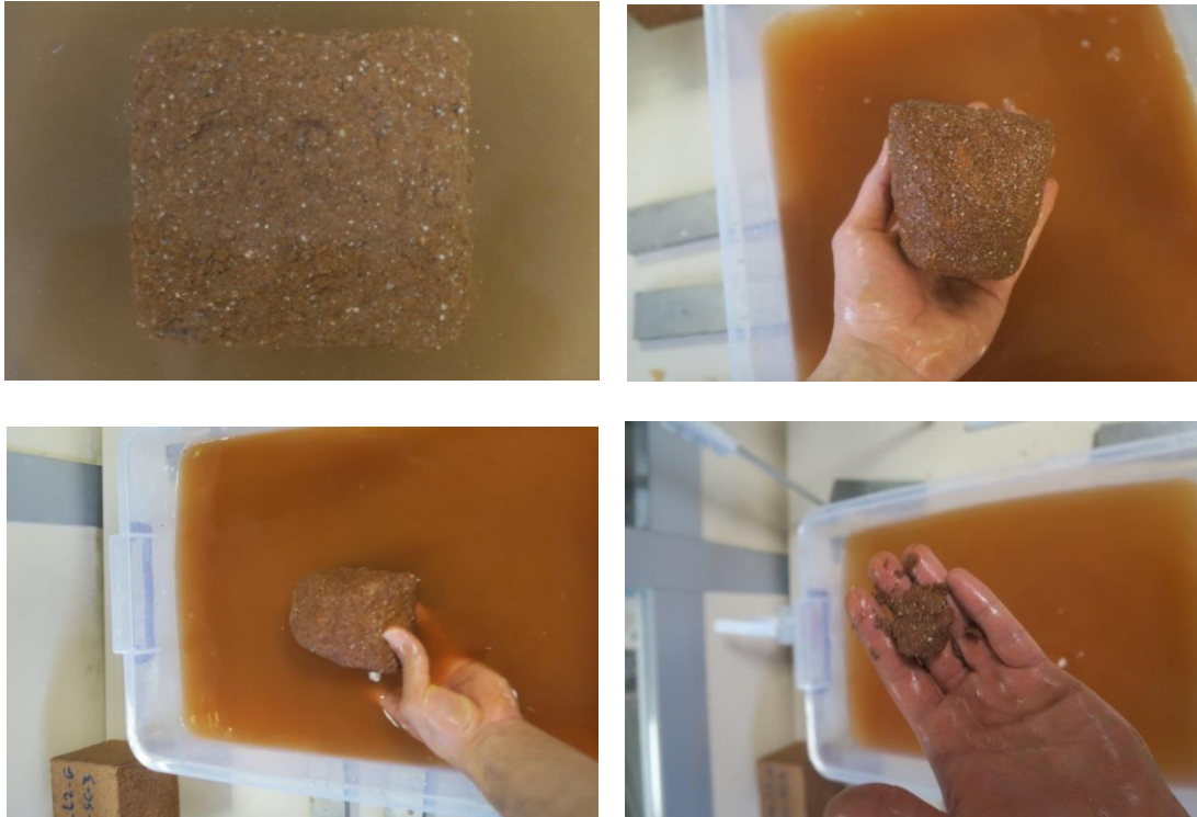
Şekil 77: %10 alçı stabilizatörlü numunelerin suya daldırıldıktan sonraki görünüşü
