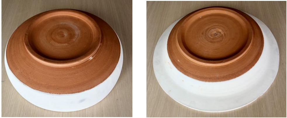
Fotoğraf 176: -a-b Dıştan yarıya kadar astarlanıp temizlenmiş hali
