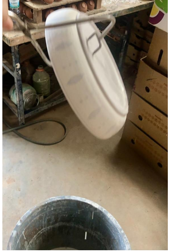
Fotoğraf 179 a-b: Daldırma yöntemi ile sırlama
