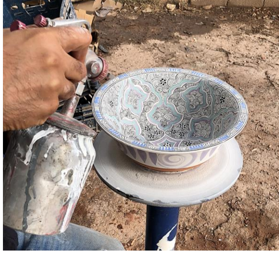
Fotoğraf 181: Püskürtme yöntemi ile şeffaf sırlama
