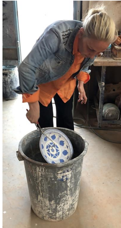
Fotoğraf 180: Daldırma yöntemi sırlama aşaması
