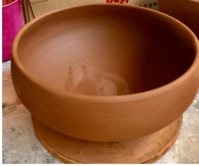
Fotoğraf 175: Deri sertliğine gelen mamülün astarlanmak için hazırlanması
