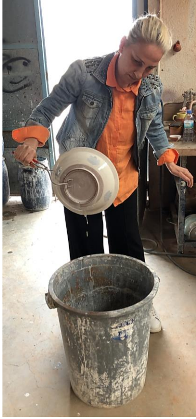
Fotoğraf 179 a-b: Daldırma yöntemi ile sırlama
