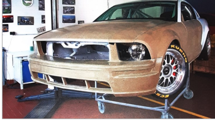
Şekil 3. 8: BioConcept - Car'ın üstyapı bileşenleri; keten tohumu yağı akrilat ile empenye edilmiş keten - pamuklu bir tekstilden yapılmıştır.
