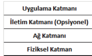
Şekil 6: wM-Bus protokolünün OSI referans modeli
