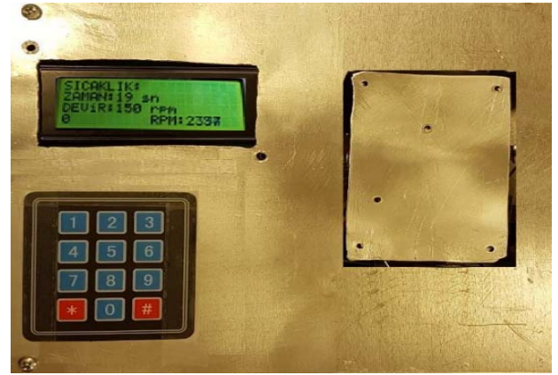
Şekil 7. Prototip ısıtıcı manyetik karıştırıcı cihazının üstten görünümü
