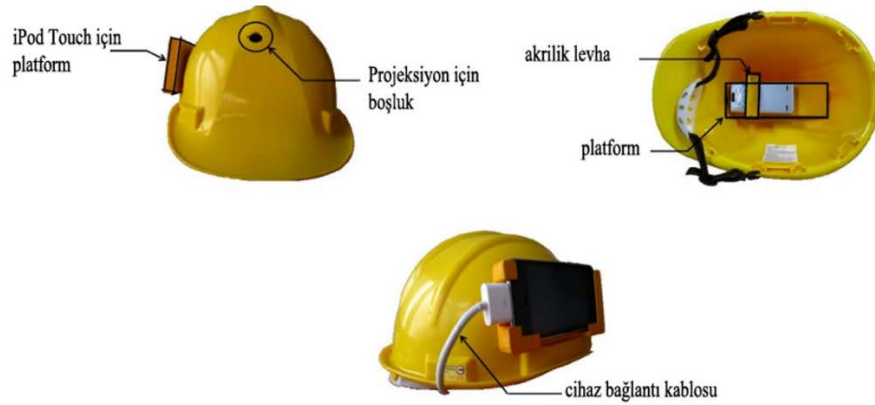
Şekil 2.6 iHelmet cihaz donanımı. (Yeh ve diğerleri., 2012)
