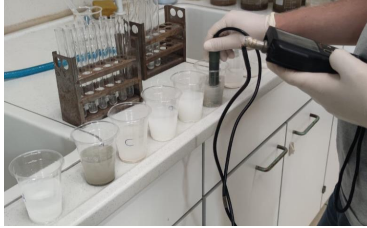
Şekil 4.8: Hazırlanan numunelerde iletkenlik ölçümü yapılması
