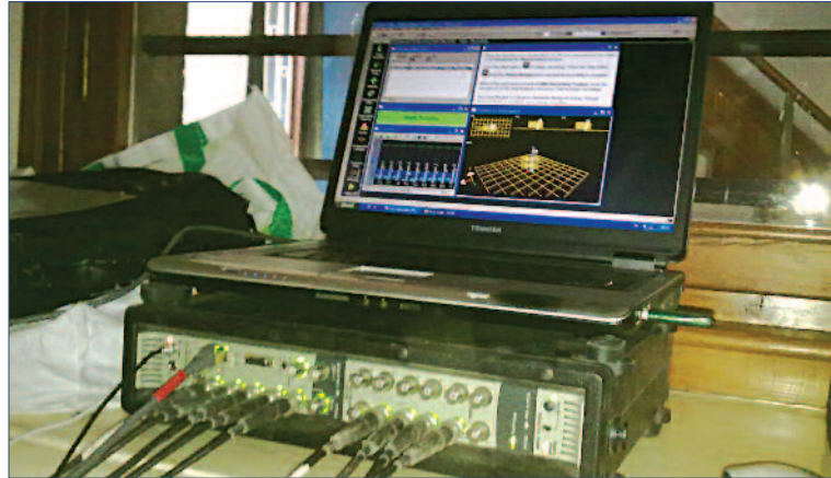
Resim 4. Deneysel ölçüm düzeneği (Veri toplama ünitesi bilgisayar ve ivme ölçerler).
