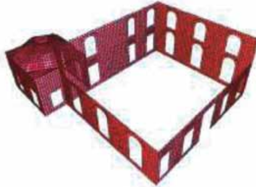
Şekil: Çatı ve bazı duvarların kaldırılmış olduğu duruma ait sonlu elemanlar modeli
