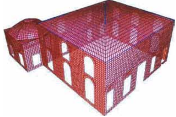
Şekil 12. Yapısal değerlendirme raporundan sonlu elemanlar modeli 1.
