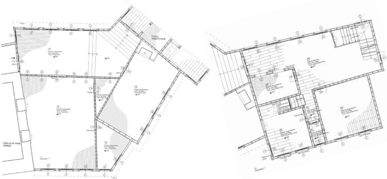
Plan 3- Çırağan caddesi yönünde 4 nolu ve 5 nolu meşrutalara ait rölöve planı (Pekerler İnş.t Tic. ve San. Ltd. Şti tarafından hazırlanmıştır.)
