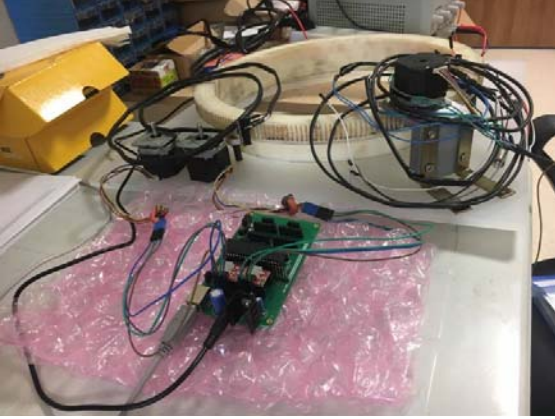
Şekil 1. Parçalar birleştirilmeden önceki radyal mekanizma, ana elektronik kart, nema17 adım motorlar
