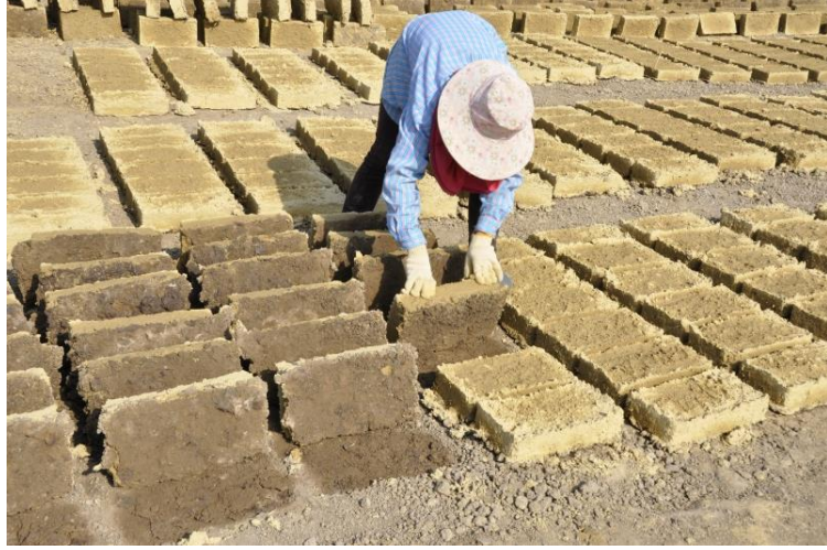
Resim 2. 3: Kurutulmaya bırakılan kerpiç bloklar (URL 17).
