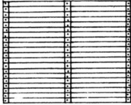
Şekil 2. 9: Bağdadi duvar görünümü çizimi (Budak v.d., 2004).
