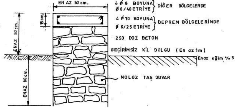
Şekil 2. 12: Kerpiç yapılarda betonarme hatıllı temel duvarı (TS2515).
