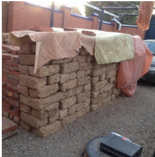
Resim 2. 4: Güneş altında kurumuş kerpiç blokların depolanması (URL 18).
