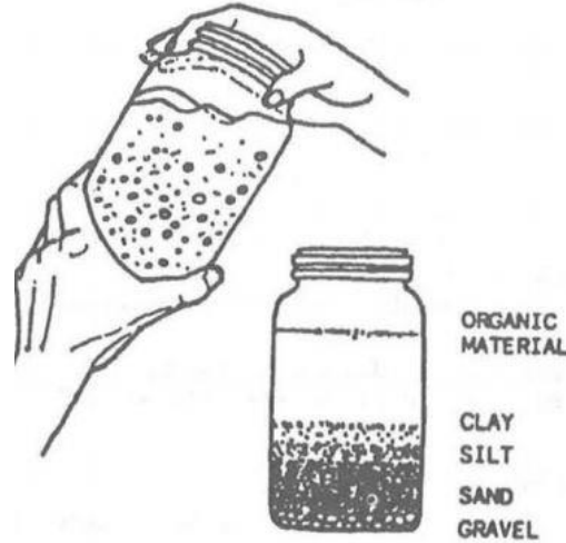
Şekil 3. 1: Sedimentasyon testinin yapılışı (Habitat, 1992).
