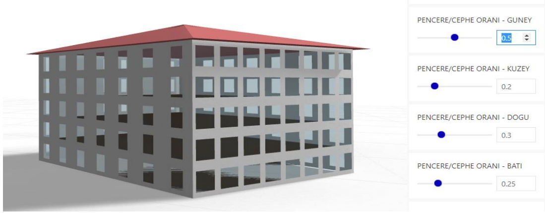
Şekil 5. 4: Pencere / Brüt Cephe Oranını Kontrol Eden Parametreler.
