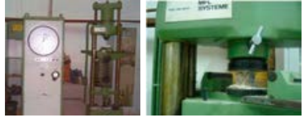
Şekil 21. a) Tek eksenli basınç yüklemesi, b) Nokta yüklemesi test metodu
